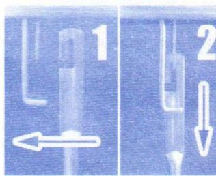
**Passo 10:** Encaixe o Gancho do Motor (17) no Suporte de Teto (16) certificando-se de que ele está completamente encaixado.
